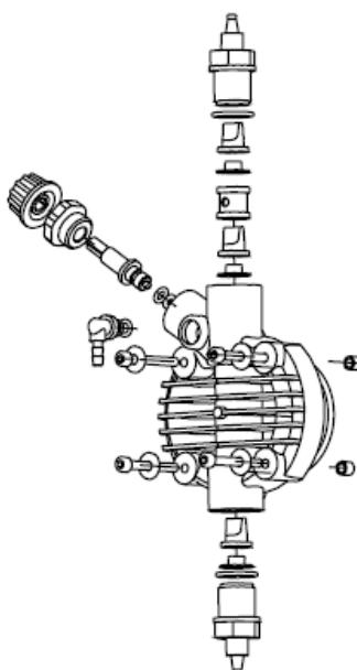
**ПРЕДУПРЕЖДЕНИЕ:** при фиксировании головки насоса четырьмя фиксирующими винтами, используйте динамометрический ключ (гаечный ключ с ограничением по крутящему моменту), с установкой усилия 1,8N x m.
