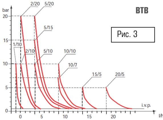
Диаграммы на рис. 3 показывают максимальный перепад производительности насоса в зависимости от рабочего давления системы; на диаграммах также учтены потери на клапане впрыска реагента, где **i.v.p.** – свободный впрыск без противодавления с подсоединенными клапаном впрыска.
