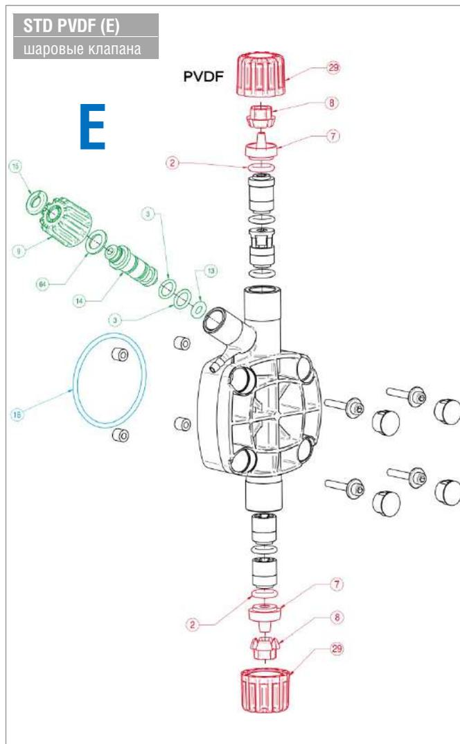
**Залипающие клапана (Lip Valves) головок насосов 30-80 л/ч**
