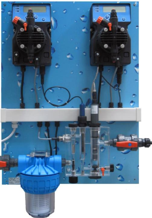
**POOL GUARD 3 PH/CL PANEL (SONDA CL)** – автоматическая система пропорционального дозирования и контроля уровня PH и CL (концентрации свободного хлора в воде) для плавательных бассейнов, объемом до 500 м<sup>3</sup>. Станция дозирования управляется по датчику потока жидкости (входит в комплект), при отсутствии потока система переходит в режим ожидания.
